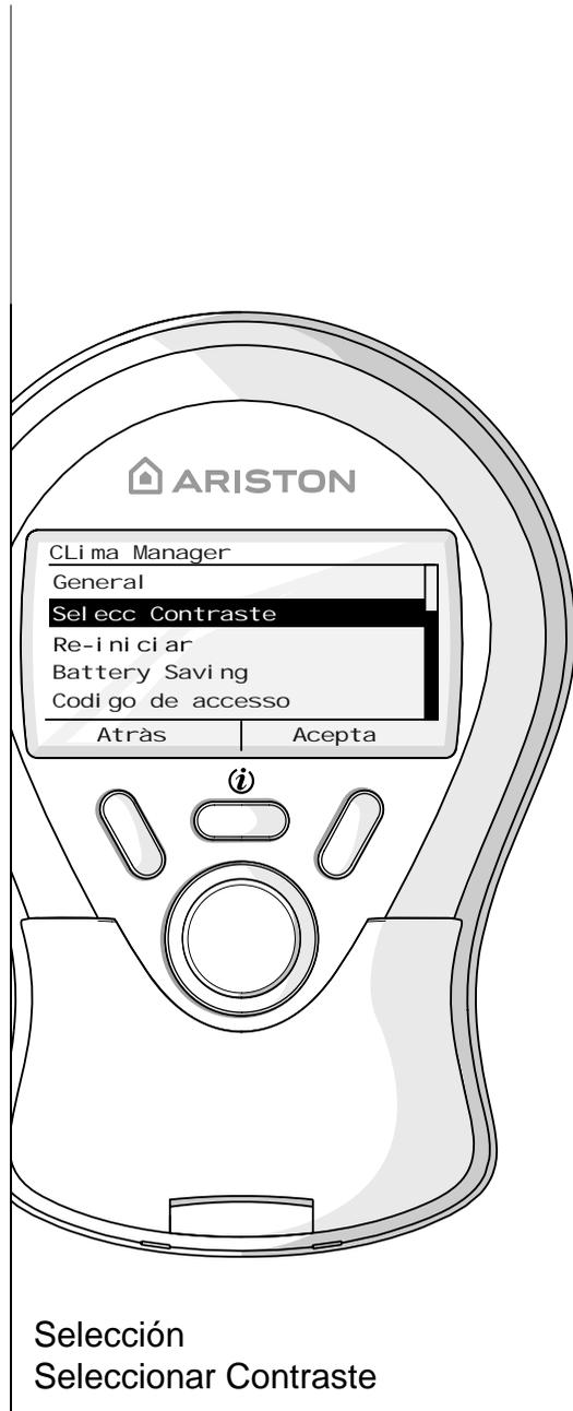
Girar el pomo y seleccionar "Código de acceso", presionar el botón de confirmación. Girar el pomo para introducir el código de acceso y presionar el botón de confirmación.
